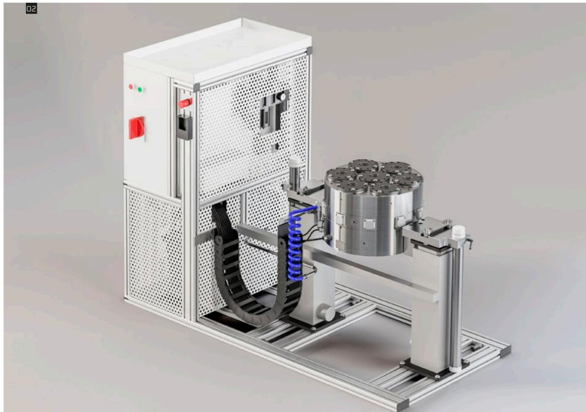
02 STARK Rüststation als Gesamtlösung: Ergonomisch höhenverstellbare Rüststation ermöglicht hochgenaues Einrichten von Turbinenteilen in der Luftfahrtbranche. Ein hydrostatisch gelagerter Rundtisch mit STARK Nullpunkt Spannsystem garantiert minimalste Abweichungen zwischen Rüststation und Bearbeitungsmaschine.
