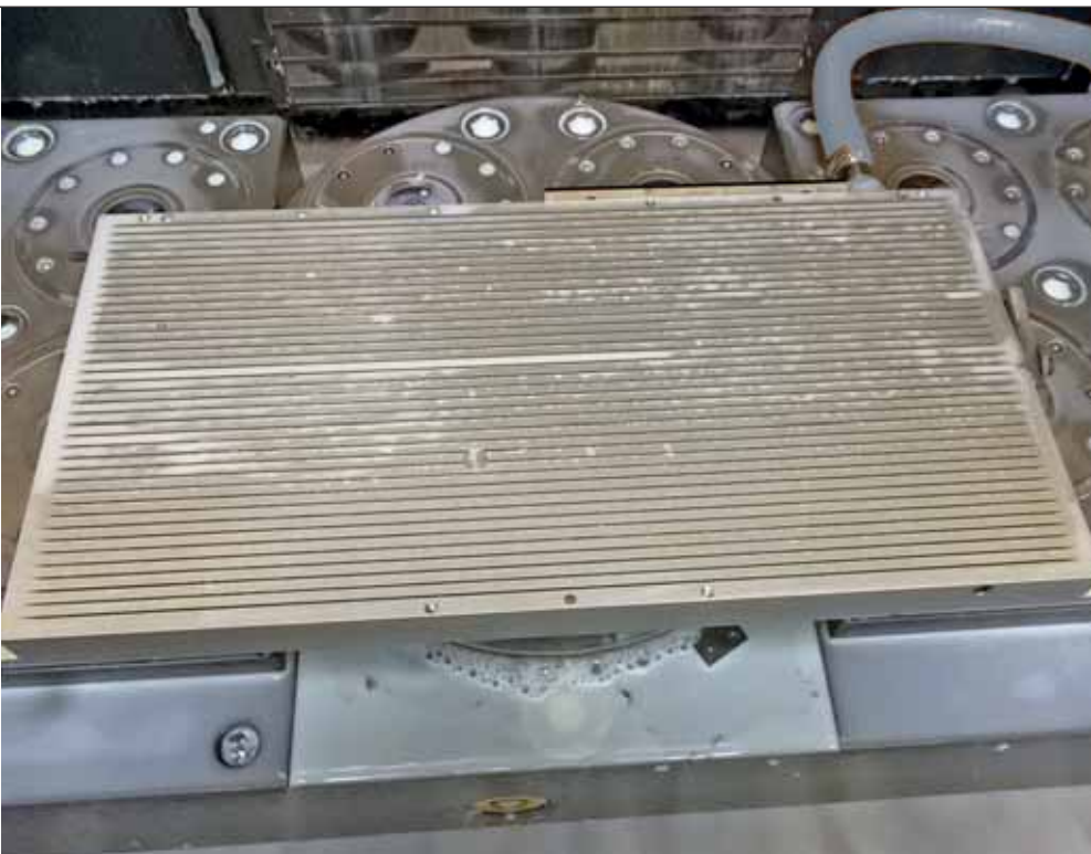
Schlitz-Vakuum-Spannplatte gespannt auf einem Nullpunktspannsystem.
