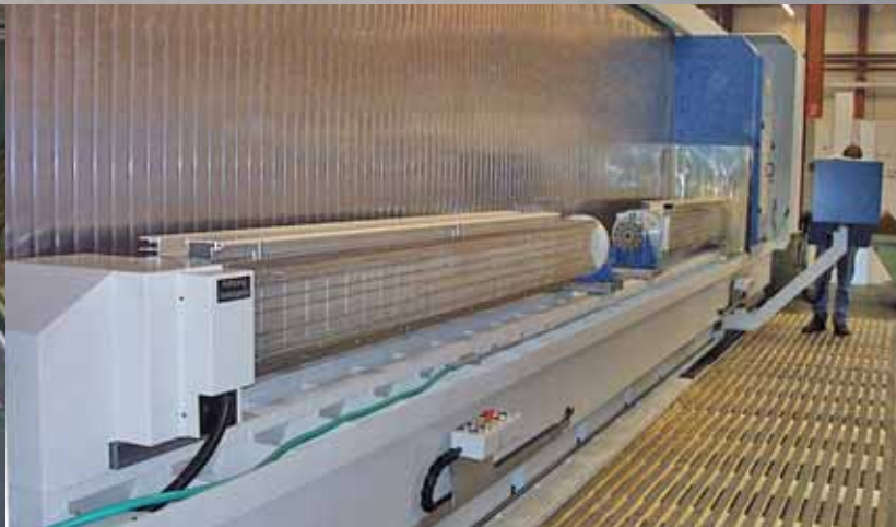
Horizontale Wendespanner 300x3500 mm mit Vakuum - Spannplatten auf 4 Seiten zur Auf- nahme von Alu-Profilen.
