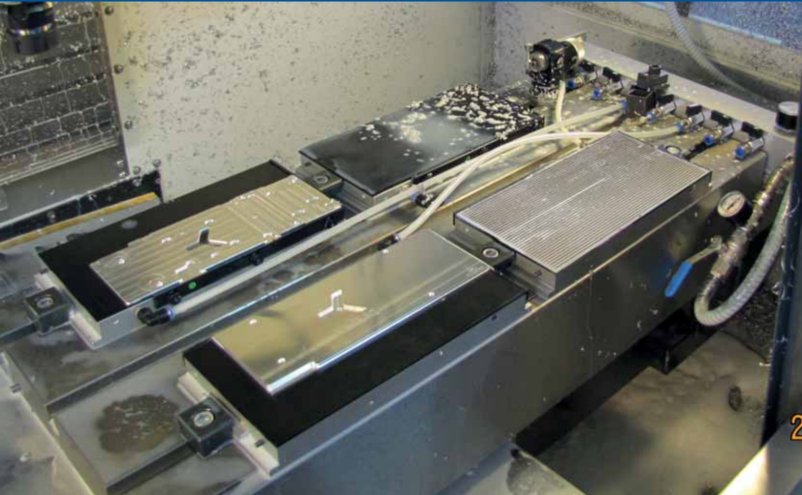
4 Schlitz-Vakuum-Spannplatten in der Produktion, bei der Herstellung von Aluminiumträgern. Durchfräsbearbeitungen von inneren und äußeren Konturen mittels Gummiadaptermatten
