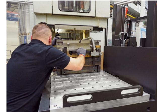
**Bild 1.** Der Wechselwagen kann direkt an die Spritzgießmaschine gefahren werden. Durch die hydraulischen Kugelleisten lassen sich auch schwere Werkzeuge leicht in jede Richtung verschieben © Römheld
