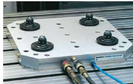
Maschinentisch Grundplatte mit 4 Einzugsselementen
