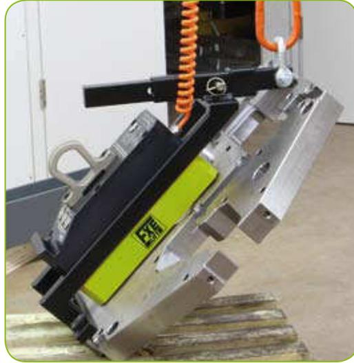
FXE HV-Vorrichtung zum horitontalen/vertikalen Heben
