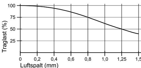
Poltyp 100 ist konzipiert zum Heben von Grobblechen ab 12mm und massiven Stahl-, Form- und Schmiedeteilen mit größerem Luftspalt. Die Nennangaben der FXE Lasthebemagnete mit Poltyp 100 werden bis zu einem Luftspalt von 0,6mm erreicht. Bei Luftspalt 0 erreicht jeder Pol 100 14,5 kN Haltekraft.
