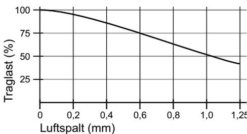
Poltyp 80 ist konzipiert zum Heben von Blechen ab 8mm und massiven Stahlteilen und Brennschnitten mit mittlerem Luftspalt. Die Nennangaben der FXE Lasthebemagnete mit Poltyp 80 werden bis zu einem Luftspalt von 0,4mm erreicht. Bei Luftspalt 0 erreicht jeder Pol 80 9 kN Haltekraft.
