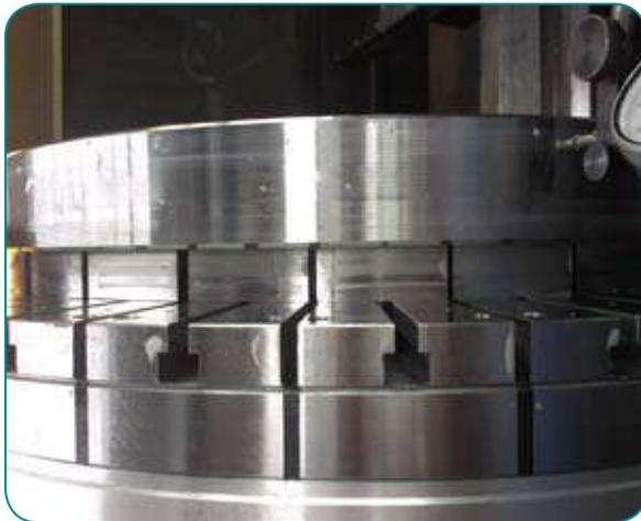
Zum Freistellen des Werkstücks können Polleisten auf die Radialpole aufgebaut werden, auf Wunsch bieten wir das RSA mit T Nuten in den Polen an. Mittig kann eine Durchgangsbohrung mit maximal Durchmesser C eingebracht werden, der Bereich B ist magnetisch nicht aktiv.
