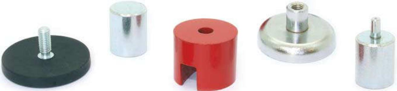
Die in den Tabellen angegebenen Haftkräfte sind Nennwerte bei Raumtemperatur, die bei senkrechtem Abriss und vollflächiger Auflage der Stabgreifer auf Werkstücken genügender Dicke aus Weicheisen oder Baustahl erreicht werden. Bei unsauberen Polflächen oder unebenen Werkstücken bilden sich Luftspalte, durch welche die Haftkräfte stark gemindert werden. Es empfiehlt sich, stets für eine saubere Polfläche zu sorgen und diese gegebenenfalls von Zeit zu Zeit zu reinigen.
