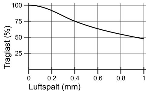
Poltyp 50+ hat ein verstärktes Magnetsystem bei gleicher Polgröße wie der Poltyp 50. Hierdurch werden bei schlechteren Oberflächen bessere Haltekraften erzielt, speziell auch wenn Polverlängerungen benötigt werden, kommt der Poltyp 50+ zum Einsatz. Bei Luftspalt 0 erreicht der Pol 50+ 3,8 kN Haltekraft.
