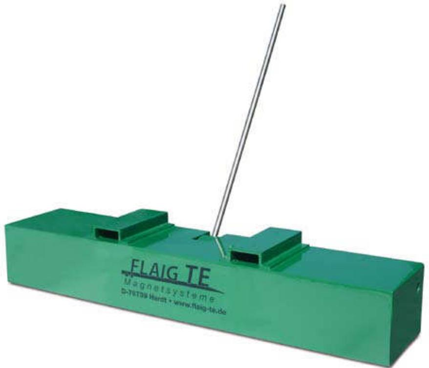
GRM-XL Magnete bestehen aus einem superstarken Neodym Magnetsystem, das extrem stabil in einem Stahlgehäuse mit Edelstahlbodenplatte verbaut ist. Sie werden einfach an der Staplergabel aufgenommen und über den Boden geführt. Die aufgenommenen Teile können dann durch Umlegen des abnehmbaren Schalthebels vom Magneten gelöst werden. So können Metallabfälle direkt über einem Container oder Behälter abgeworfen werden.
