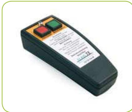
Fernbedienung in Funk oder IR Technik. Zur Fernbedienung bieten sich sowohl Funk als auch IR-Technologie an. IR hat Preisvorteile, benötigt aber einen direkten Sichtkontakt zum Empfänger und hat eine geringe Reichweite von nur ca. 5m. Funk hat eine Reichweite von mindestens 30m, daher empfiehlt sich aber auch beim Einsatz einer Funk FB zusätzlich die Option „Hebeösensor“.
