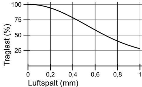
Poltyp 50 ist konzipiert zum Heben von Blechen ab 4mm und Stahlteilen mit ebener oder bearbeiteter Oberfläche. Die Nennangaben der FXE Lasthebemagnete mit Poltyp 50 werden bis zu einem Luftspalt von 0,3mm erreicht. Bei Luftspalt 0 erreicht der Pol 50 3,8 kN Haltekraft.
