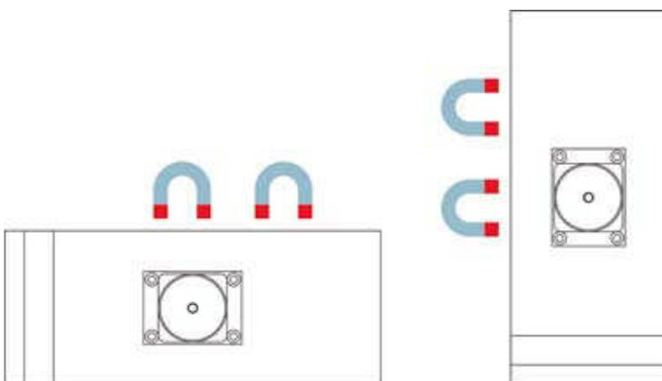
Der UNI-MILL Magnetspannblock kann sowohl senkrecht als auch waagrecht auf den Maschinentisch oder auf eine Magnetspannplatte aufgespannt werden.
