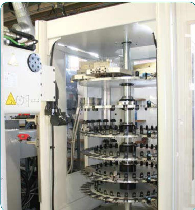
Magazin für Palettier-Magnetspannplatten und Werkzeuge
