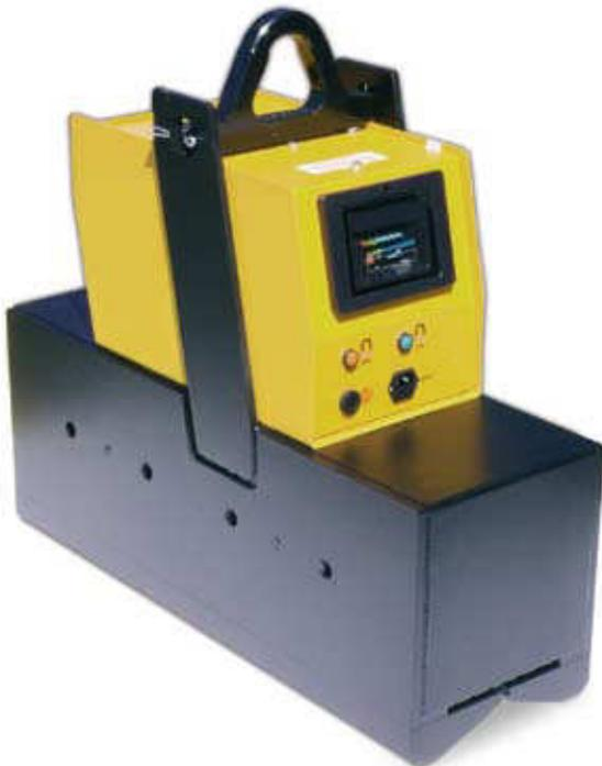
Die Baureihe FBM-P mit Prisma eignet sich für Flach-, Rund- und Profilmaterial. FBM-P 18 und FBM-P 36 besitzen besondere Prismenpolschuhe, welche das Heben von Flach- und Rundmaterial sowie Profilmaterialien wie Trägern oder Winkeleisen ermöglichen. Die maximale Tragfähigkeit wird bei Materialien ab 50 mm Dicke erreicht. Das besonders tiefe Magnetfeld dieser Modelle sorgt auch bei schlechten Oberflächen noch für sicheren Halt.
