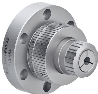
Durch die mechanische Hubeinstellung kann die Spannkraft begrenzt werden, dadurch können sehr dünnwandige Werkstücke bis zu einer Wandstärke von 0.25 mm deformationsfrei gespannt werden. Die mechanische Hubeinstellung ist von aussen her zugänglich und kann direkt auf der Maschine eingestellt werden.
