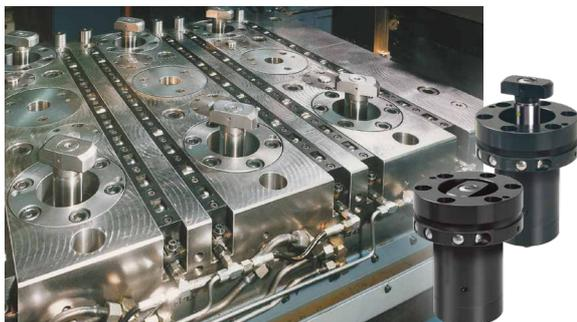
Schwenk-Senkspannelemente in einer Doppelständerpresse (Zuganker ausgefahren in Schwenkposition)
