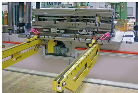
An die Presse adaptiertes Werkzeug-Wechselsystem
