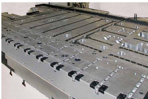
Rollenleisten mit hydraulischer Anhebung integriert in einen Pressentisch
