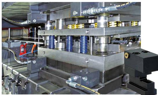
Einschubspanner mit T-Nutenfuß in Pressentisch und Stößel, Rollenleisten und Tragkonsolen für den Werkzeugschub
