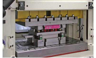
Magnet-Spannsysteme M-TECS M
