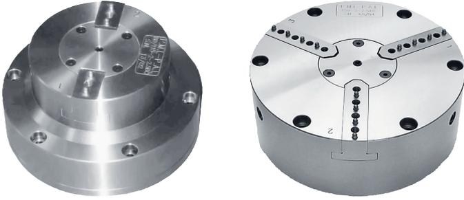
Avec cylindre de serrage pneumatique intégré, corps de plateau en acier, mors de base en acier à outils trempé, avec / sans passage pour fluide de refroidissement, avec mors de rechange.
