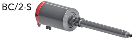
Avec raccord pour les tuyaux d'amenée d'air à double ou triple flux du commerce, pour la commande du plateau de serrage pneumatique. Passage tournant à double palier. A utiliser avec de l'air nettoyé et huilé.
