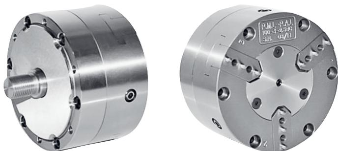
Corps de plateau en acier, mors de base en acier à outils trempé, sans passage pour fluide de refroidissement, avec mors de rechange, avec goujon tirant pour une utilisation avec vérin de serrage.
