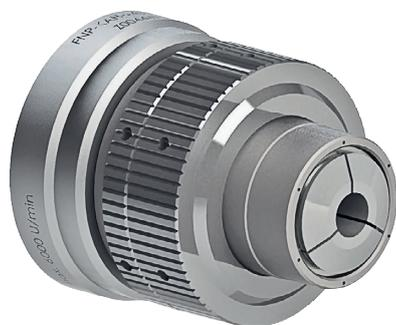
Grâce au réglage mécanique de la course, il est possible de limiter la force de serrage, ce qui permet de serrer sans les déformer des pièces à usiner aux parois très minces (jusqu'à 0,25 mm d'épaisseur). Le réglage mécanique de la course est accessible de l'extérieur et peut être directement fait sur la machine.
