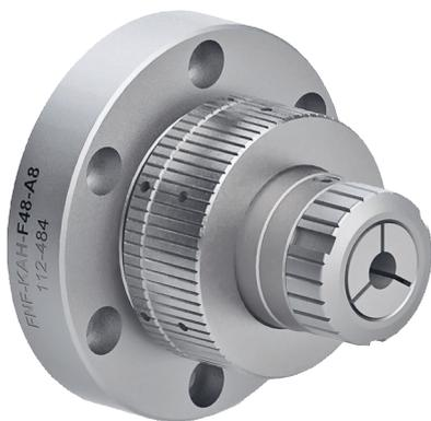
Grâce au réglage mécanique de la course, il est possible de limiter la force de serrage, ce qui permet de serrer sans les déformer des pièces à usiner aux parois très minces (jusqu'à 0,25 mm d'épaisseur). Le réglage mécanique de la course est accessible de l'extérieur et peut être directement fait sur la machine.
