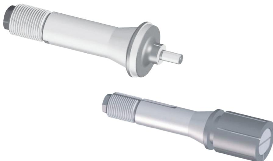
Les tasseaux expansibles sont destinés à serrer des pièces par l'intérieur. Ils se distinguent des pinces échelles par leur construction garantissant une meilleure concentricité et permettant le serrage de pièces plus longues et de diamètre plus réduit. Ces tasseaux ont été développés dans les types les plus courants pour les machines SCHAUBLIN et les machines semblables permettant l'adaptation de tels accessoires. Ils sont livrables dans les deux exécutions suivantes :
