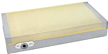
Plateaux magnétiques permanents, type Neomicro2, plateaux de haute précision pour le bridage de petites pièces et pièces de faible auteur pour travaux de rectification de précision et pour l'électroérosion. La faible hauteur du champ magnétique empêche une magnétisation des outils d'usinage. Le plateau est activé au moyen d'un levier de commande six pans amovible.
