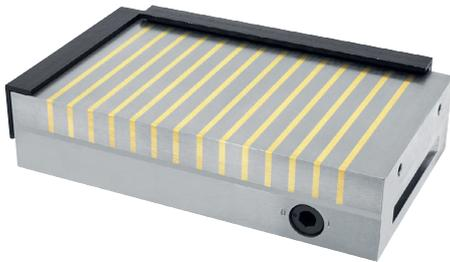
Plateaux magnétiques permanents, type Neomill ; plateaux compacts superpuissants pour l'usinage lourd. Il est possible de brider des pièces à partir d'env. 30x15x6 mm avec des forces de maintien max. possibles. Même avec des surfaces rugueuses, on obtient encore de bonnes forces de maintien. Le plateau est activé au moyen d'un levier de commande six pans amovible.
